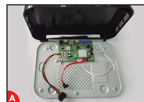
Odpojte NVR od napájení, vyšroubujte šroubky a sejměte horní kryt.
