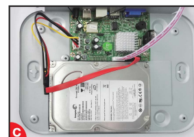
Umístěte disk HDD do rekordéru dle ploch pro uchycení. Kabeláž umístěte kolem disku HDD.
