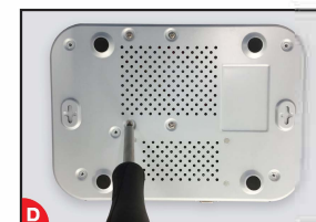
Pomocí šroubků uchyťte disk HDD ze spodní strany rekordéru. Nasuňte horní kryt a upevněte šroubky.
